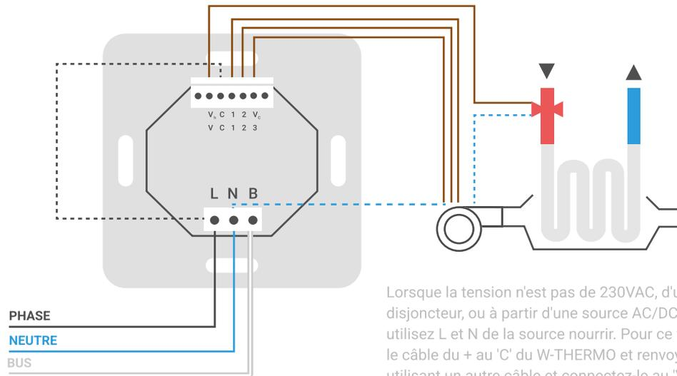
Lorsque la tension n'est pas de 230VAC, d'un autre disjoncteur, ou à partir d'une source AC/DC non identifiée, utilisez L et N de la source nourrir. Pour ce faire, connectez le câble du + au 'C' du W-THERMO et renvoyez ce signal en utilisant un autre câble et connectez-le au 'V' du W-THERMO.
