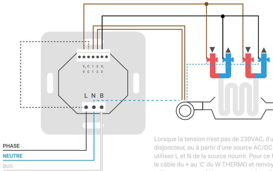
Lorsque la tension n'est pas de 230VAC, d'un autre disjoncteur, ou à partir d'une source AC/DC non identifiée, utilisez L et N de la source nourrir. Pour ce faire, connectez le câble du + au 'C' du W-THERMO et renvoyez ce signal en utilisant un autre câble et connectez-le au 'V' du W-THERMO.
