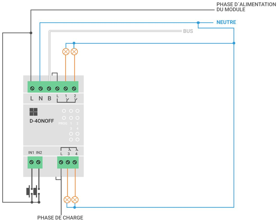
**Interrupteur 4x ON/OFF 16A rail DIN**
