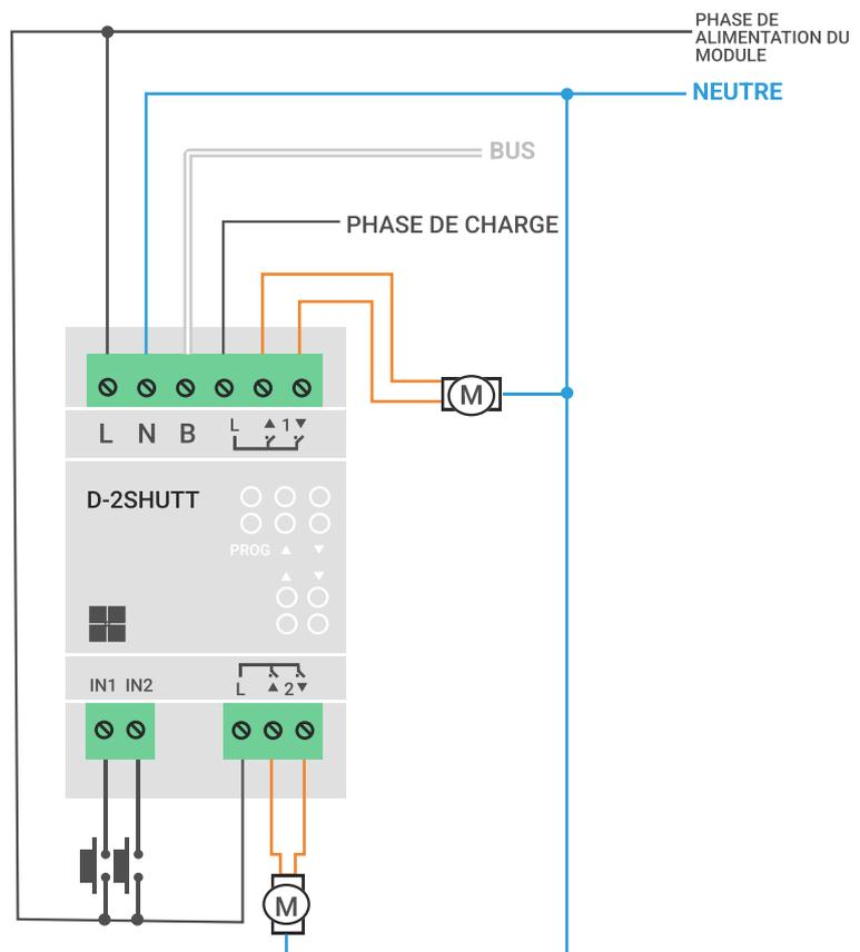
Ne dispense pas de l'existence et réglage de fin de cours dans le moteur
