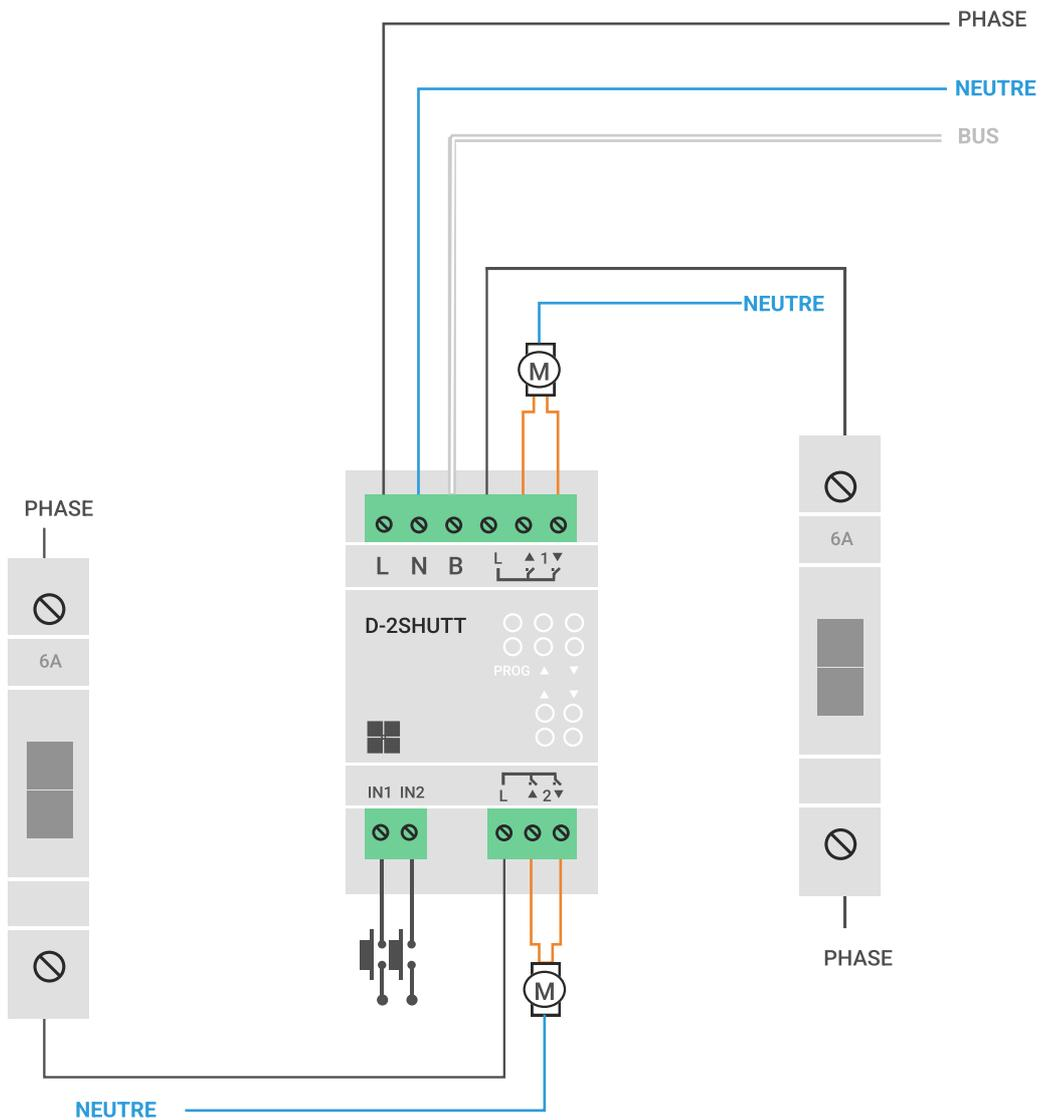
Ne dispense pas de l'existence et réglage de fin de cours dans le moteur.
