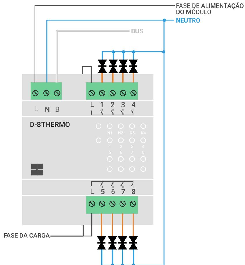
Termóstato para piso radiante 8 zonas calha DIN
